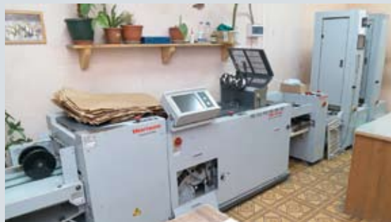
Послепечатный комплекс оборудования типографии для производства книг как в твердом переплете с шитьем нитками, так и в мягкой обложке с КБС, а также брошюр на скобе
